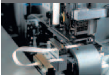
Leiterbahnen crimpen mit integrierter Crimpkraftüberwachung CFA
