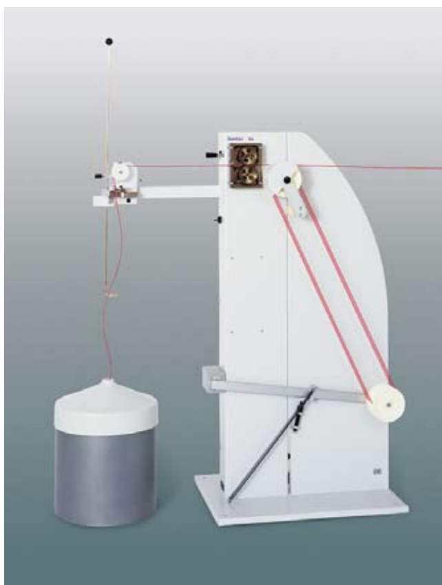
Bild 1: Vorstation k106 zum schonenden Zuführen
