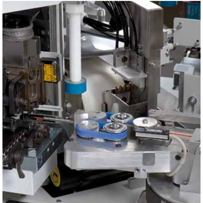
Crimppresse, Schwenkarm Seite 1 und Messerkopf
