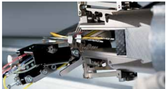
Motorisierte Transferbrücke für ein schonendes Kabelhandling
